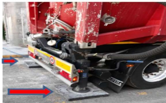
Vozač postavlja podnožje ispod stabilizatora vozila (dva ili četiri u zavisnosti od tipa vozila)
