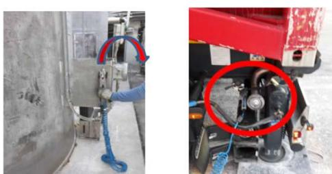
Vozač uzima stezaljku za uzemljenje i spaja je s posebnim zatvaračem koji se nalazi na cisterni.
