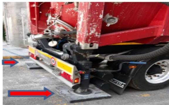
Vozač postavlja podnožje ispod stabilizatora vozila (dva ili četiri ovisno o vrsti vozila)
